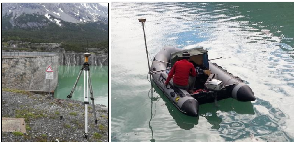
Figura 14-1: ricevitori GPS “base” posizionato a terra (a sinistra) e “rover” montato sul natante utilizzati per i rilievi morfobatimetrici (a destra)
